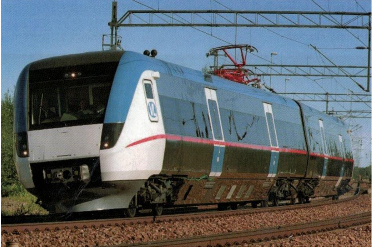
Tågfront till ett Reginatåg tillverkad i balsasandwich med fenolharts
