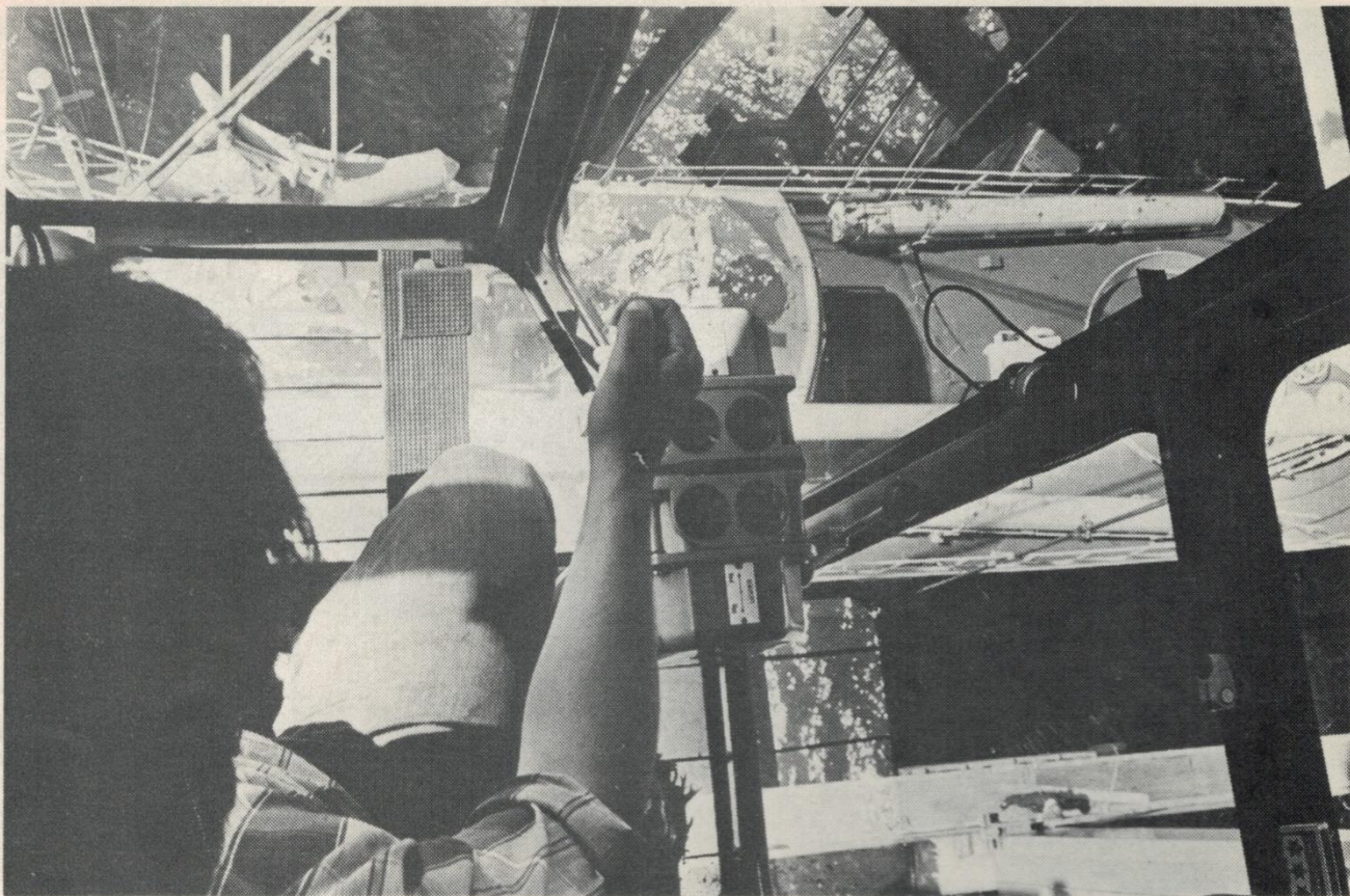
Roger Bremgård i manöverhytten på 200-tons traversen sänker ner ännu en Spica-båt i dess rätta element.
