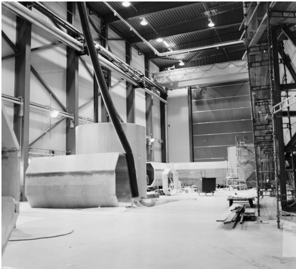
Sektionerna till vraktunneln provmonteras i kompositverkstaden
