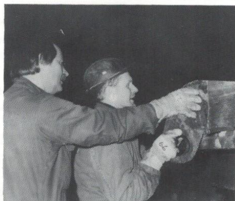
T v Rune Jonasson och Anders Stenström mäter in samt bränner loss skadat gångjärnsöra till akterramp.
