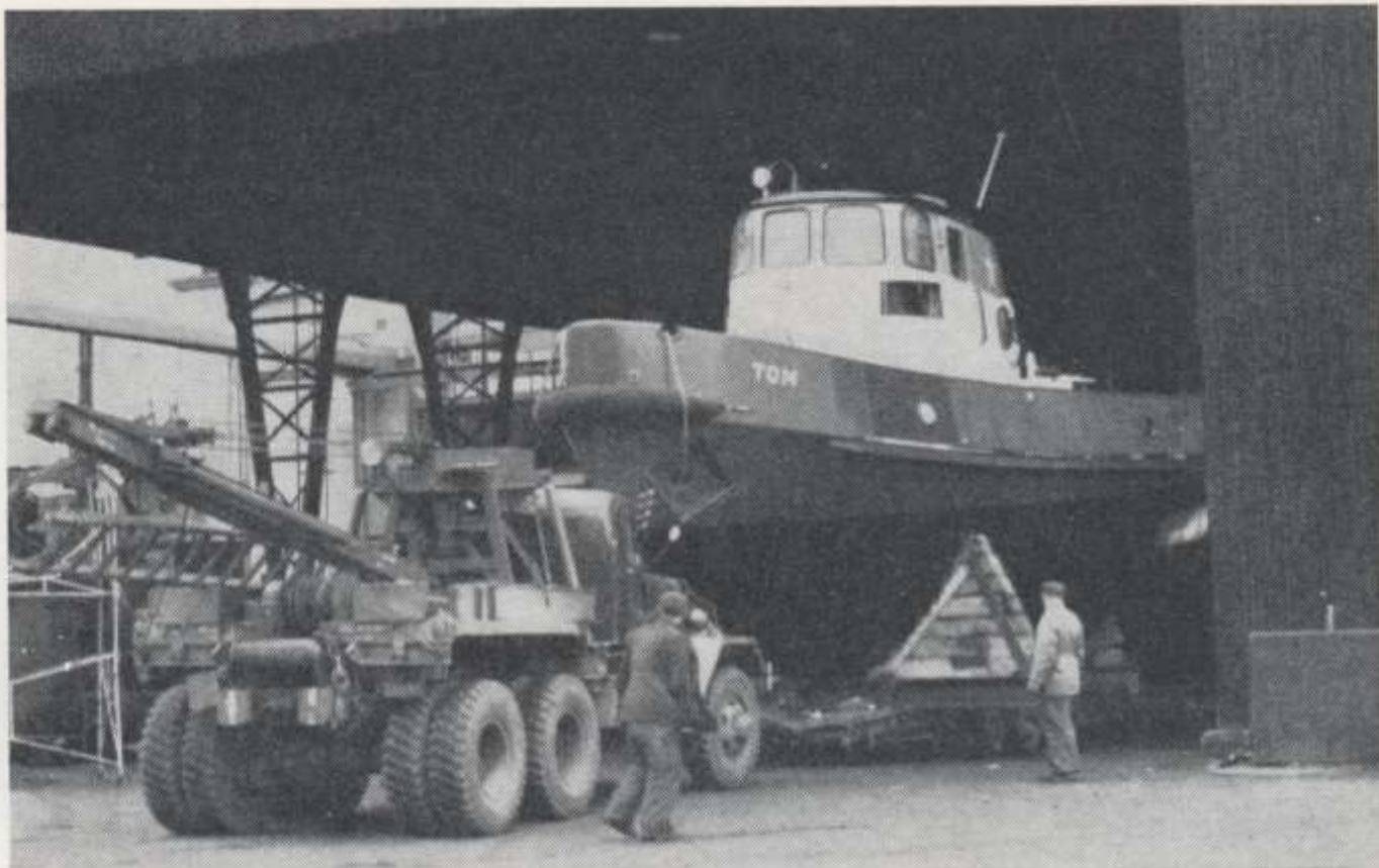
■ Bogserbåten Tom, som tillsammans med systerfartyget Tim byggdes i plåthallen, under transport till kaj för sjösättning.
