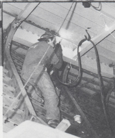
I svetshallen pågår produktion av sektioner till kustkorvetter. Nibblingen till samtliga korvetter är slutförd. I fixturerna arbetar man med tredje kustkorvetten.
