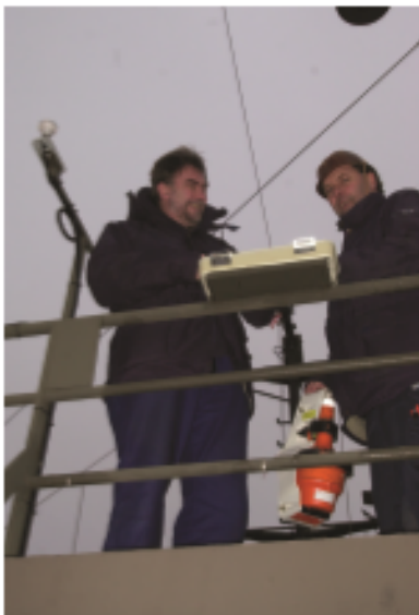
Inge Gustavsson och Inge Andersson, monterar ny nödsändare uppe på styrhustaket.
