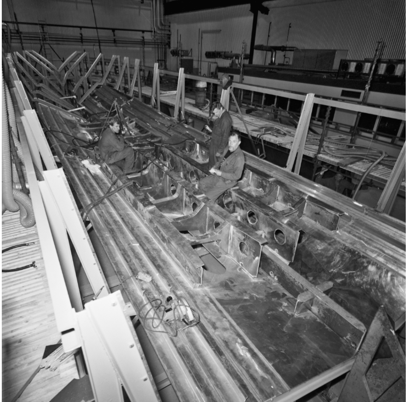
Tillverkning av KBV 301 skrov i aluminium
