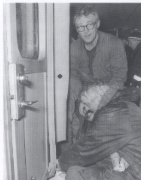
Christer Persson och Kjell Svensson monterar tätningslist i dörren till styrhytten.
