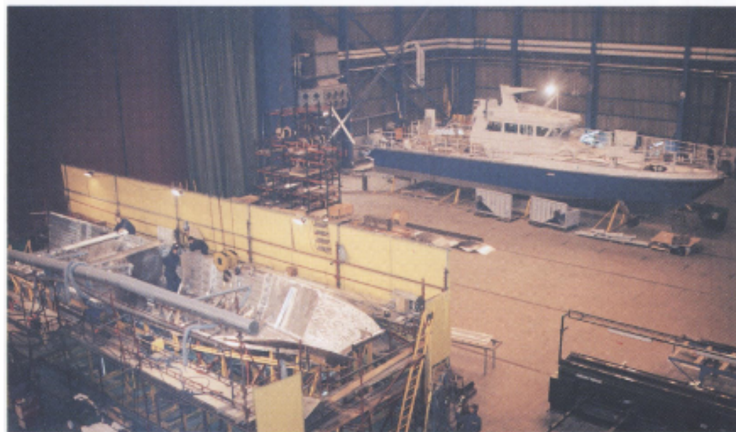
Det råder bråda dagar i flakhallen. Det första kustbevakningsfartyget i serien om tio håller nu på att utrustas för att levereras i februari. På fartyg nummer två pågår skrovtillverkningen.
