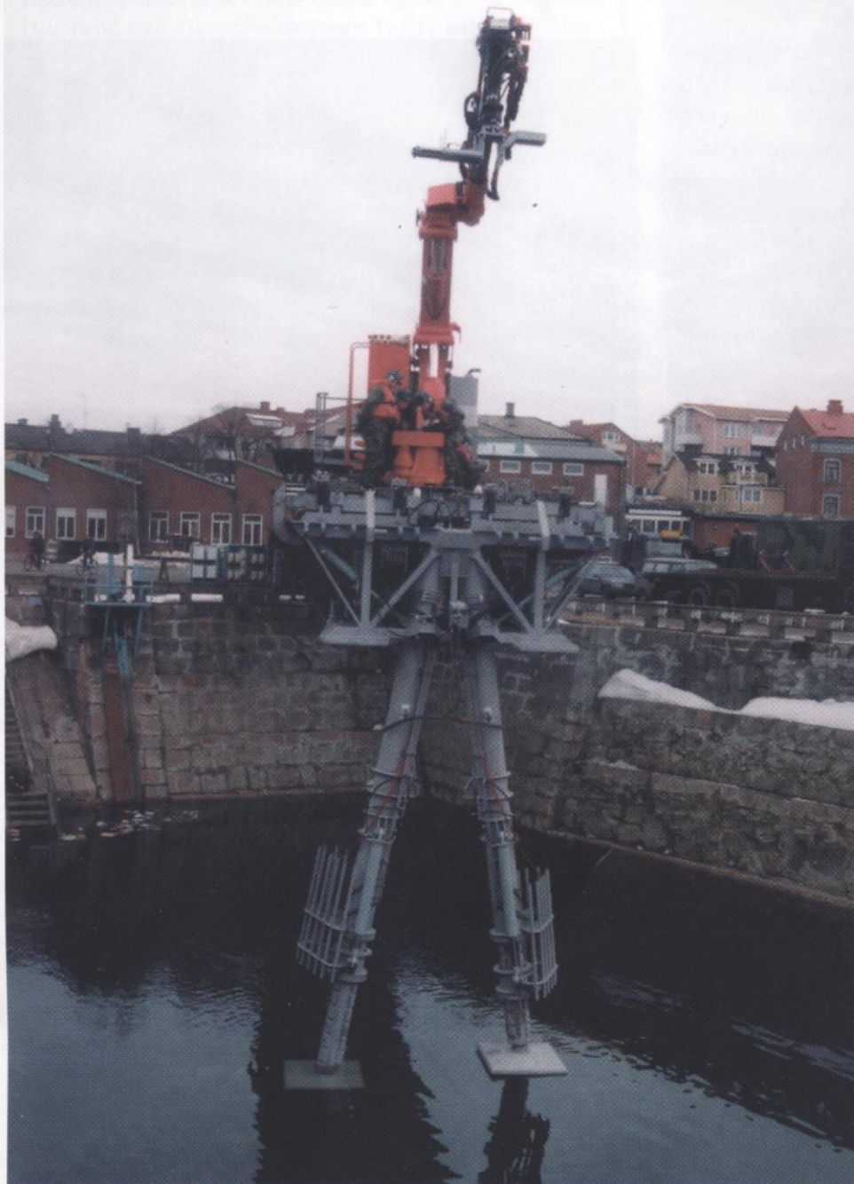
Brons stödben kan ställas in i olika längder. Maximala längden är åtta meter.
