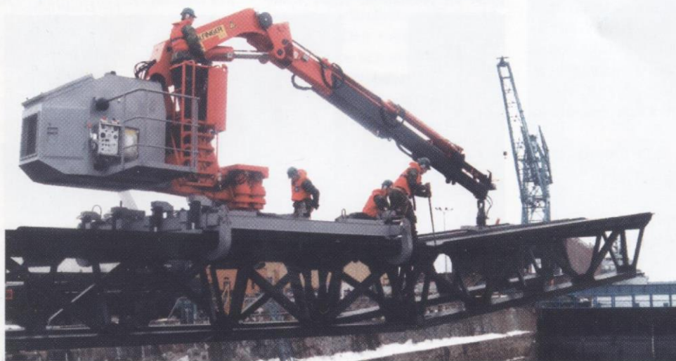
Brons stödben kan ställas in i olika längder. Maximala längden är åtta meter.
