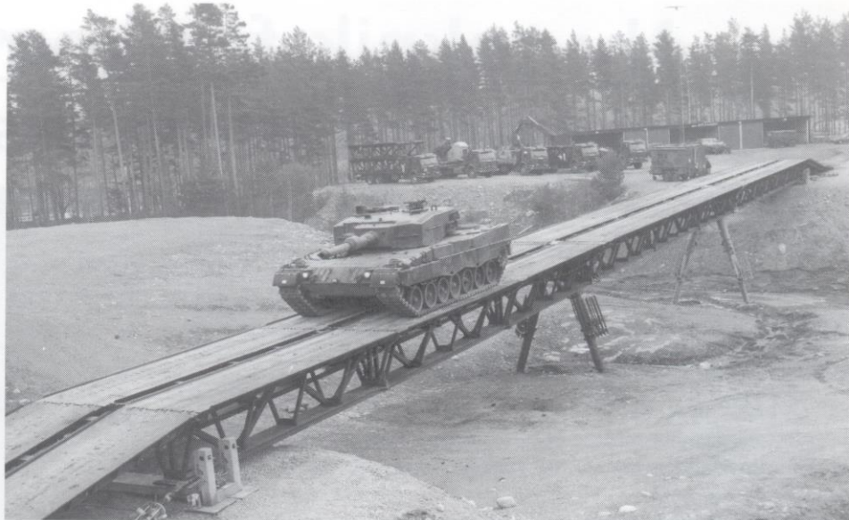
Den 54 ton tunga Leopardstridsvagnen såväl körde över som gjorde bromsprov på bron. - Bron kändes mycket stadig, konstaterade stridsvagnsföraren efteråt.
