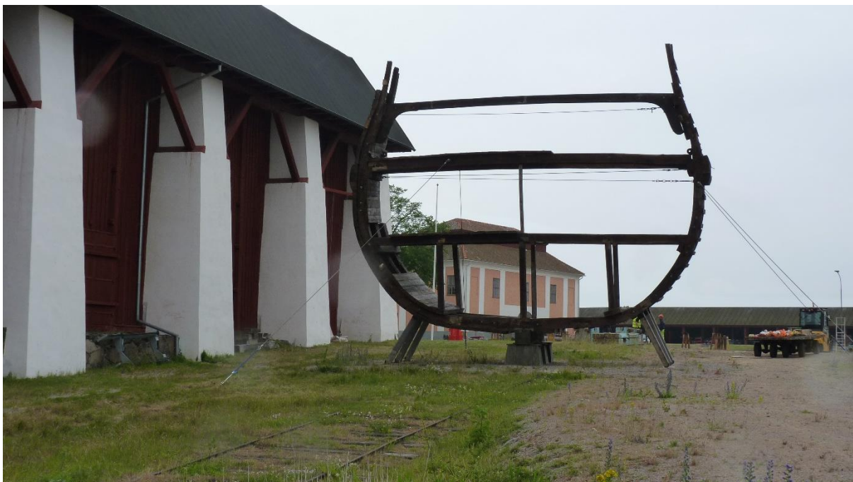
Spantsektion på plats på stapelbäddens kölblock
