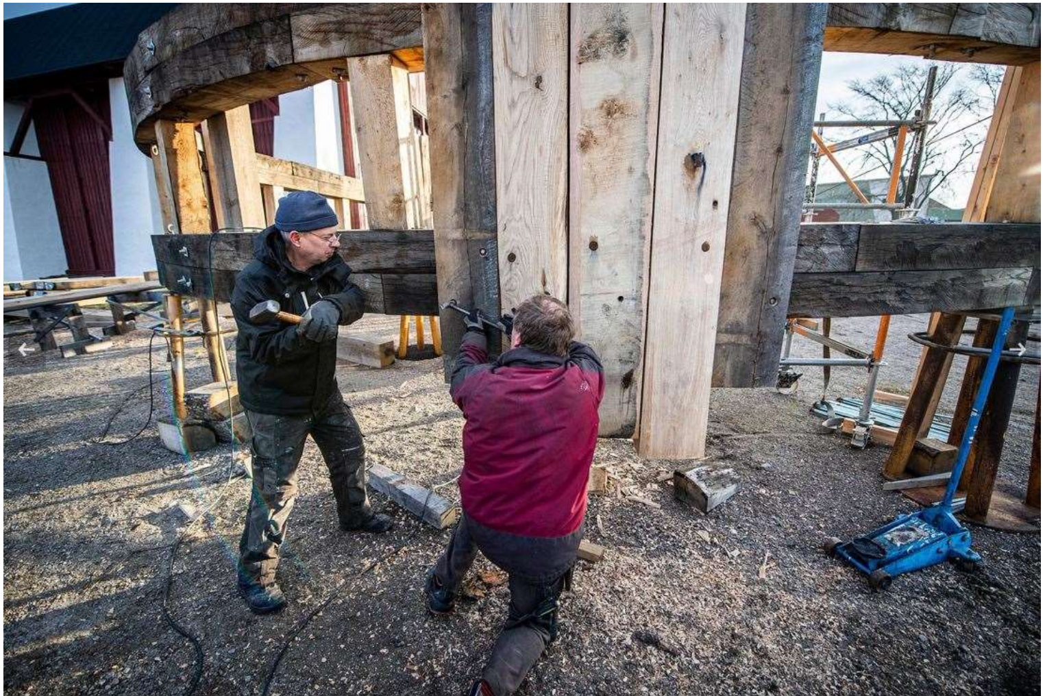
Bordläggningsplankor spikas till spanten bredvid des kraftigare förstärkningen (berghulten).
