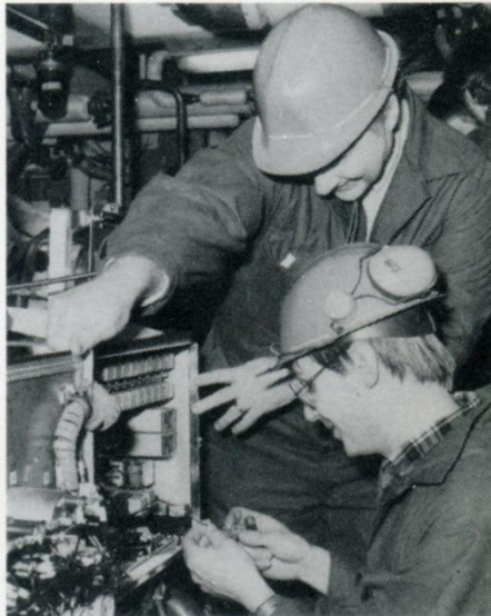
Sven-Erik Karlsson och Jan-Erik Svensson finjusterar manövrering och koppling mellan diesel- och Voith-Schneideraggregaten.
