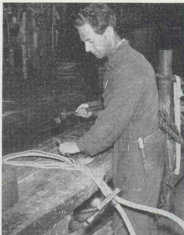
På tackelkammaren träffade vi S. Jarlebrand, som höll på att splitsa wires.
