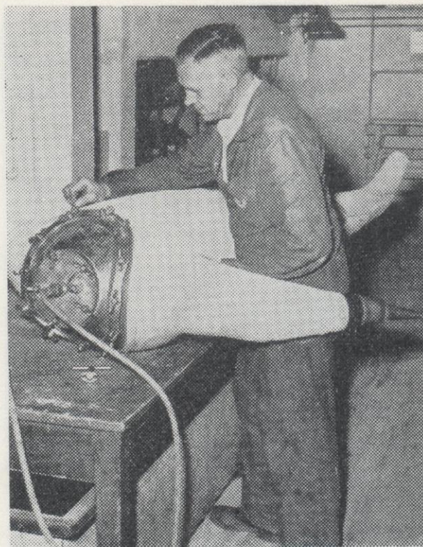
Dykardräkten måste vara absolut tät. Dykerireparatör H. Stranke håller på med täthetsprovning.
