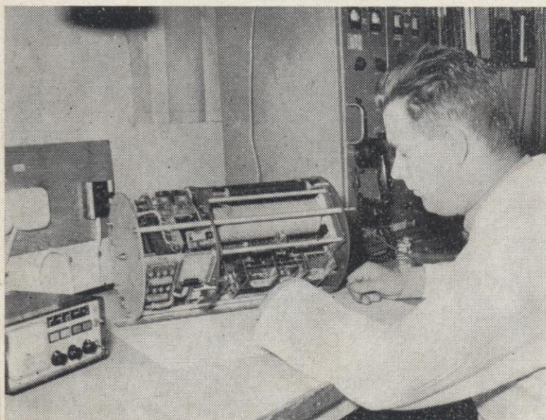
Tekniker Sven Ramström synar sin automatiska antennenpassare efter det den genomgått en del hårda prov.
