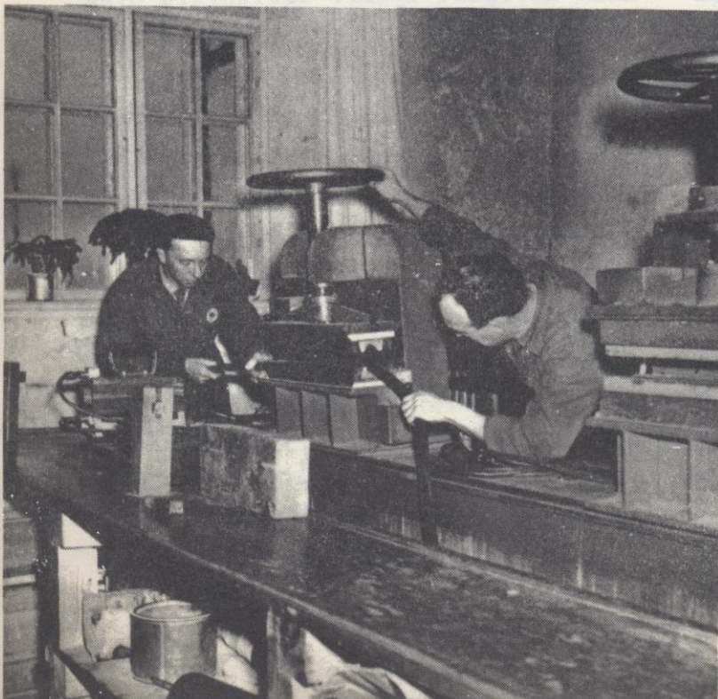
Montörerna G.Säfström och G.Olsson vulkaniserar en el.kabel till ett magnetminsvep.
