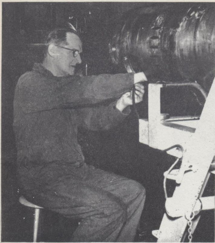
En torped har ett invecklat maskineri - montör E.Stark justerar här djup- och sidorganen.
