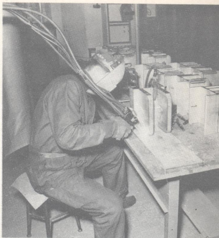
Stig Swärdh svetsar kopplingsstycken medelst en halvautomatisk MIG-svetsutrustning.
